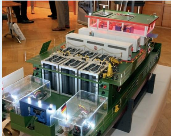
Modell der „Elektra“. Zwischen Wasserstoff-Speicher und Brücke befinden sich die Brennstoffzellen
