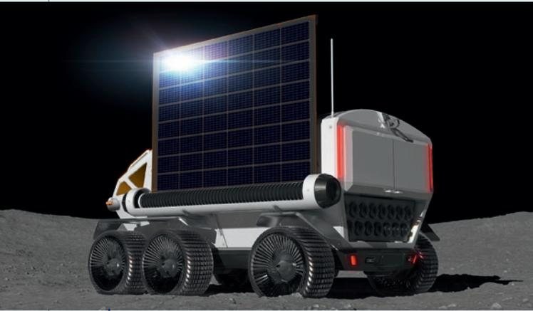
Energie bekommt das Fahrzeug durch Solarzellen und Wasserstoff (hinten unten sind die Behälter zu sehen) (Foto: Toyota)
